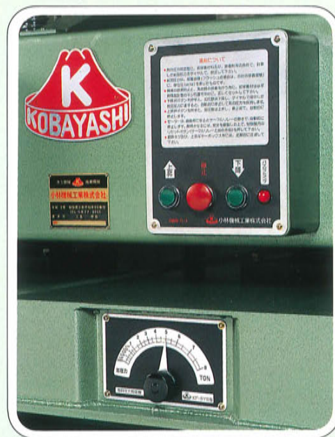
加圧力設定制御操作盤
