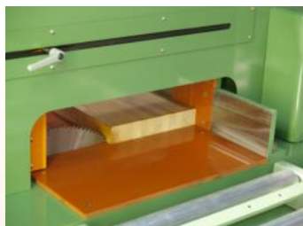
集成材の切断
